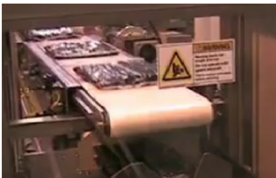
Figur 9. Pøkkeløsning (Pull nose conveyor) for plate suppeposer fra Combi Packing Systems
