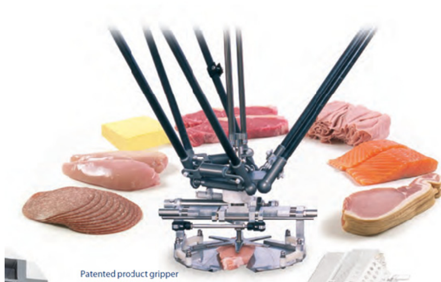
Figur 7 Marel's griper for porsjonspakking
